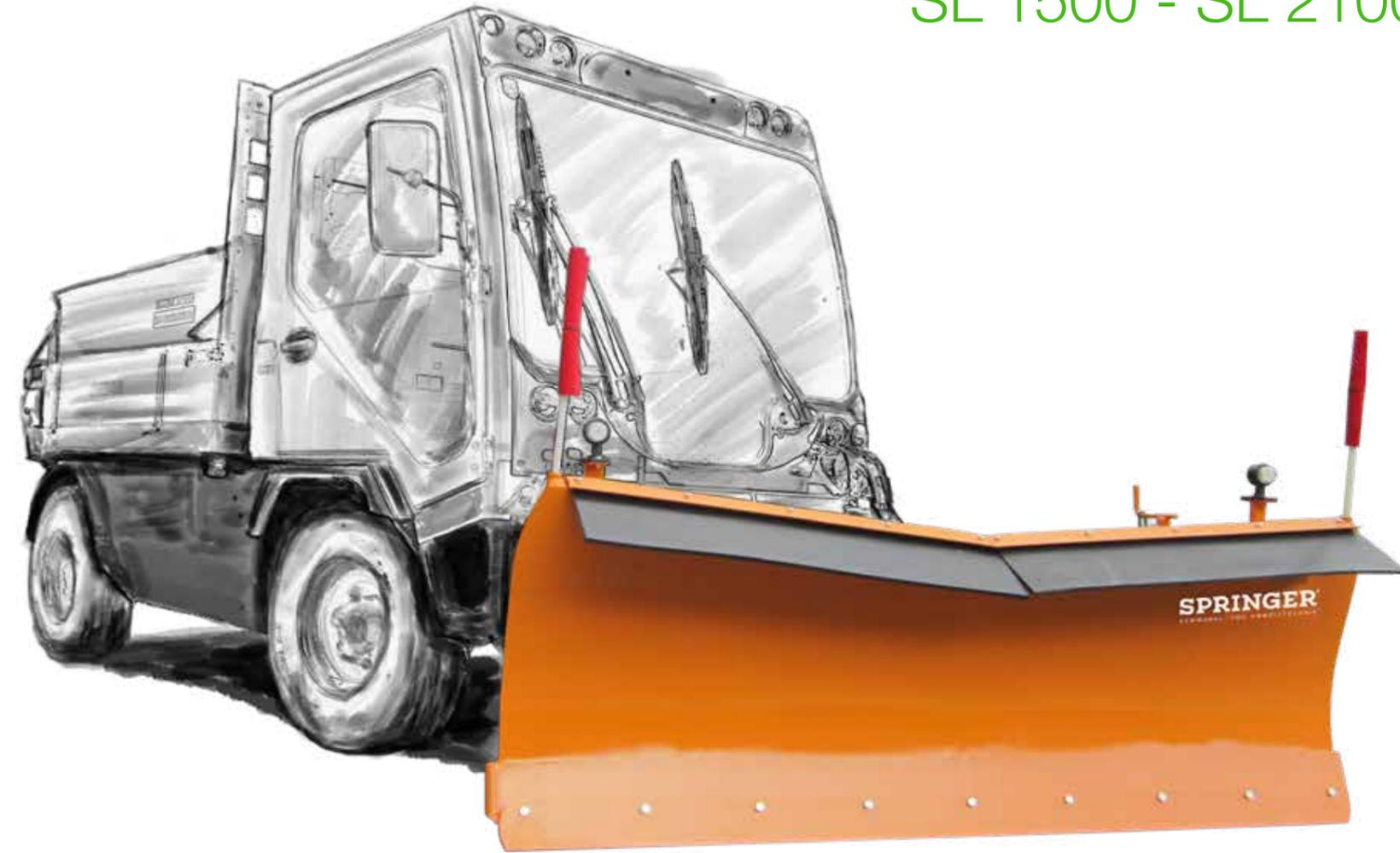
Die Seitenschneepflüge dieser Baureihe bestehen aus einem Räumschild mit Ausklinktechnik. Das ermöglicht im Besonderen einen Räumensatz bei harten, eisigen Schneedecken. Schäden am Räumgerät, am Fahrzeug und an der Straße werden so vermieden. Das erhöht die Lebensdauer des SPRINGER Seitenschneepflugs. Der Klappmechanismus des Räum-
