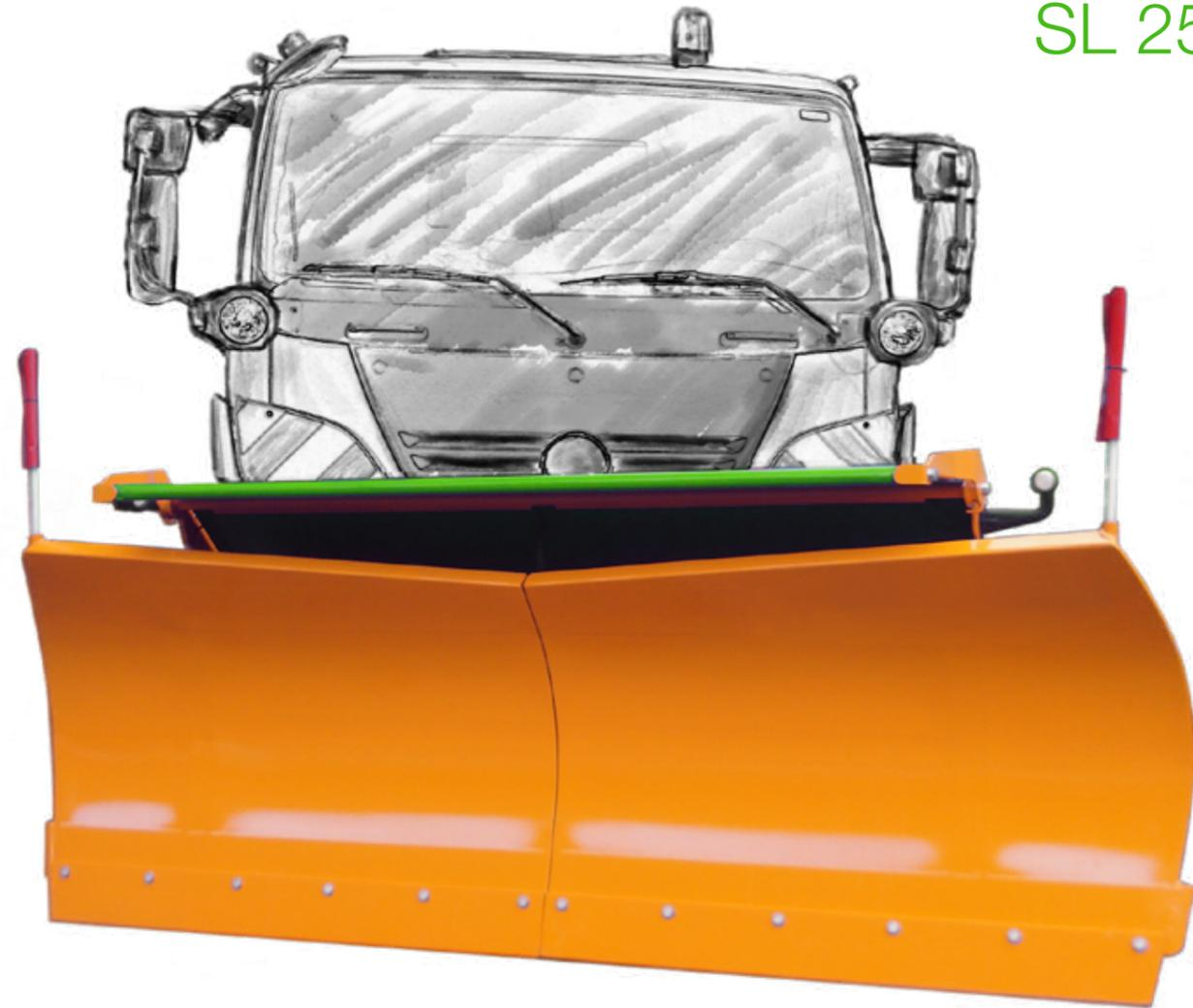
Der Klappmechanismus des Räumschildes wird von Zugfedern kontrolliert. Dadurch wird das Wegklappen des Pfluges beim Anfahren an Hindernisse ermöglicht.
